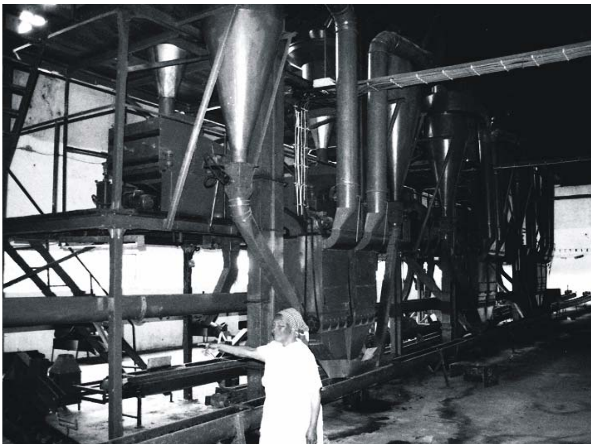
Fotografia 14. Fábrica velha – Sistema de descasque mecânico por impacto
