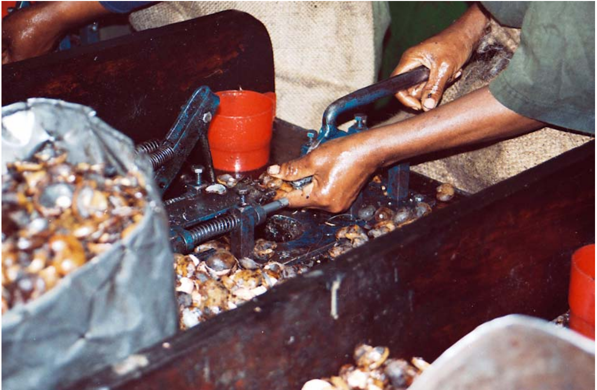
Fotografia 18. Descasque de castanha de caju com máquina manual de lâminas na fábrica de Laulane (Maputo)
